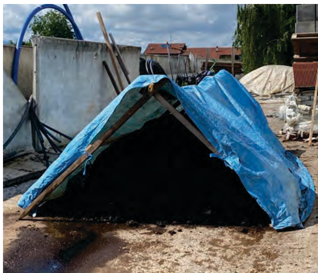
Fig. 1 – Cumulo coperto con telo non aderente per la valutazione della stabilità
