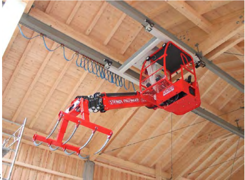
Figura 1. Essiccazione del fieno sciolto: (A) box per l'essiccazione del foraggio (B) carroponete per la movimentazione del foraggio in ingresso e in uscita
