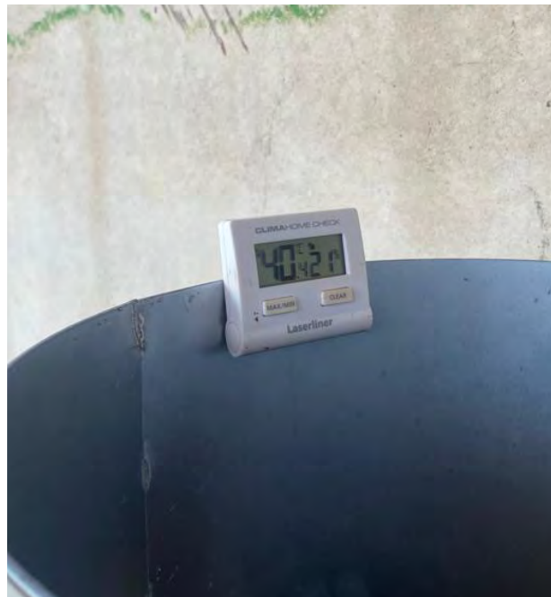
Figura 9. Sensore per la misurazione della temperatura e dell'umidità dell'aria
